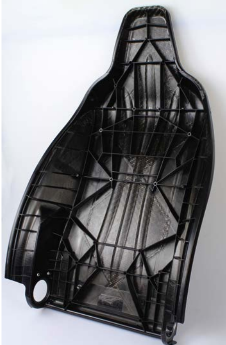
Bild 1. Sitzlehnedemonstrator der Prozessroute 1 mit angespritzten Versteifungsrippen und metallischen Inserts (© Fraunhofer ICT)
