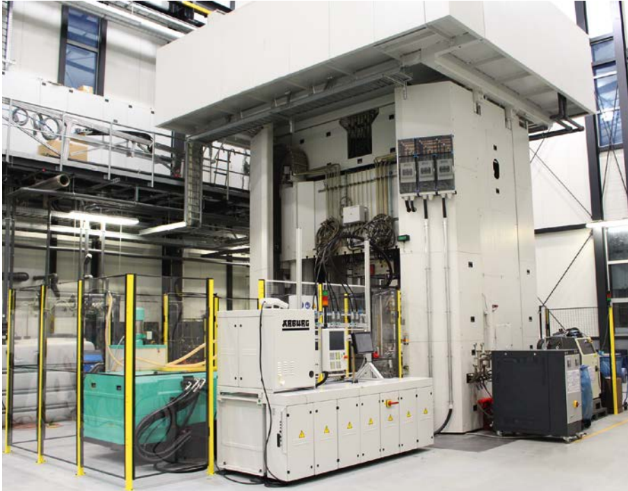
Bild 3. Modulares LFT-Spritzgießmodul, angekoppelt an hydraulische Oberkolbenpresse zum Thermoformen und Hinterspritzen der flächigen Halbzeuge (© Fraunhofer ICT)
