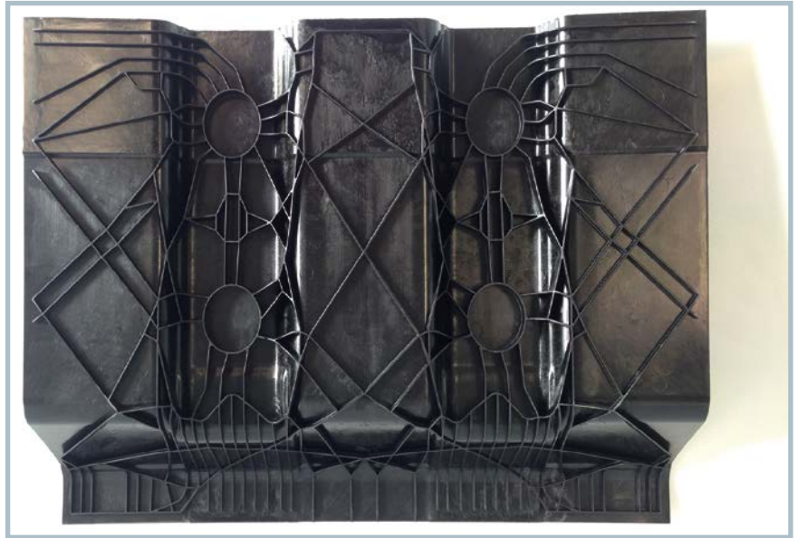
Bild 4. Unterbodensegment der Prozessroute 2 mit fließpressgeformten Versteifungsrippen
